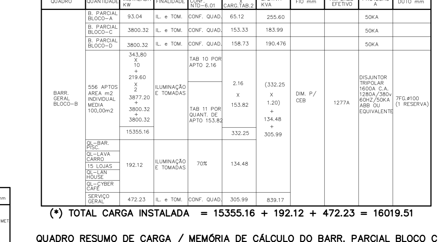
BARR. GERAL BLOCO B ESC. 1:20 QUADRO RESUMO DE CARGA / MEMÓRIA DE CÁLCULO DO BARR. GERAL BLOCO B
